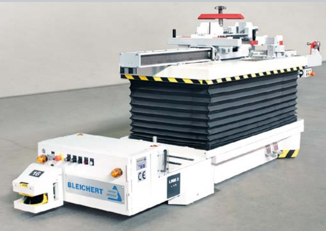
FTF mit Hubtisch und Aufnahmevorrichtung für Montagelinie von Niederflurfahrzeugen
